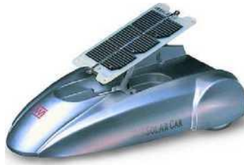
Hình 1.1. Mô hình xe hơi thử nghiệm sử dụng năng lượng mặt trời
